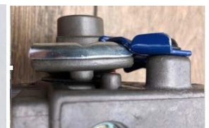
Le butoir de la tête d'urgence droite sera bloqué par le butoir de la tête de service courbée
