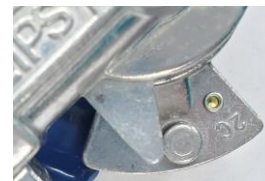
Le doigt du service est bloqué par le butoir de l'urgence
