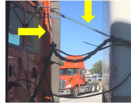
Resorte de apoyo a la izquierda y Resorte de trabajo a la derecha
